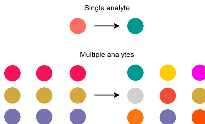
Figure 8: Haut : réponse unique d'un senseur spécifique à un analyte. Bas : réponse composite d'un sensor array pour trois analytes.
